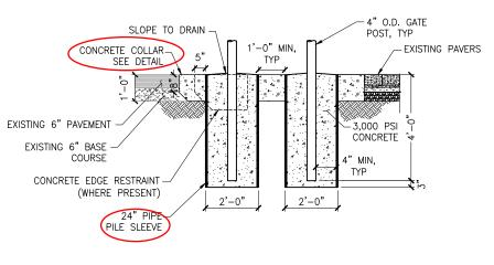
**BOX FRAME GATE POST -ASPHALT/PAVERS**
