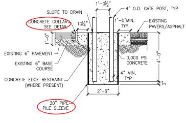
**SINGLE FRAME GATE POST -ASPHALT/PAVERS**
